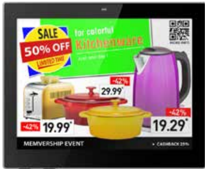
NEWTON 7 COLOR 6.0" Velikost: 133,0 x 109,0 x 14,7 mm Displej: 600 x 448 pixelů NFC 7 barev LED diod
